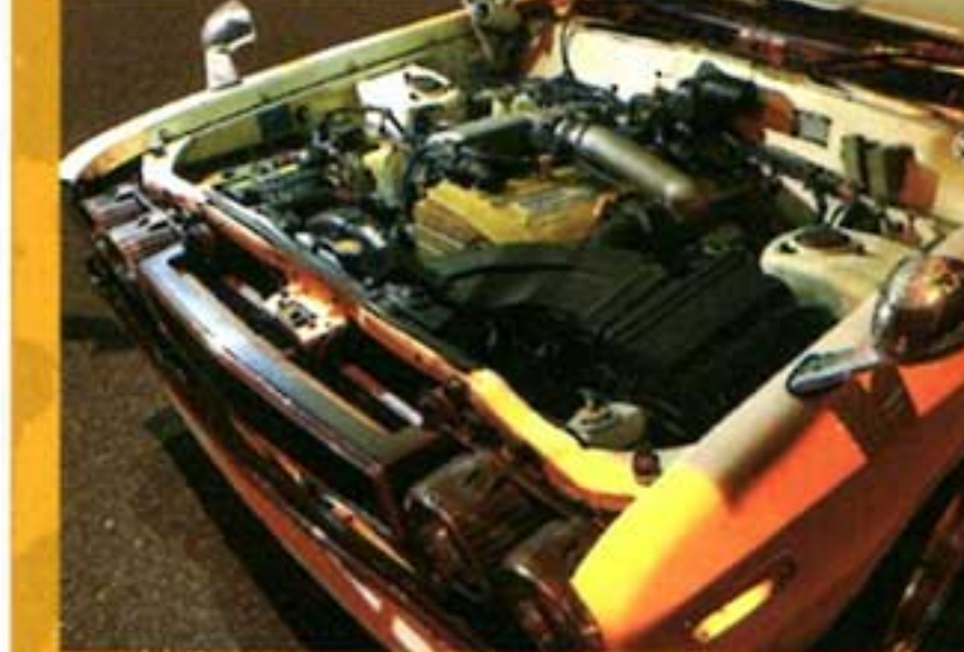
その独特なリヤスタイリングから、通称“ブタケツ”と呼ばれる、ローレルKHC130(76年式)が佐田サンのお愛車。エンジンはL20E型から、94年式のRB20型(ターボ)に換装している。佐田サンによれば、「乗り心地は正直悪いですよ。ボク運転するとスイッチが入っちゃってるみたいで、嫁はいつも酔ってます(笑)」と、助手席の人には決して優しくはないようだが、エアコンパワステを完備するなど街の快適性は十分確保されている。また、写真にはないのが残念だが、シートはノーマルのまま使用されており、佐田サンお気に入りのポイントでもある。
